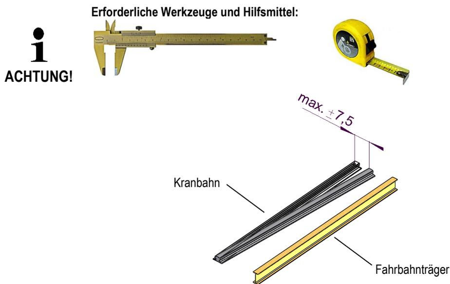
Abb. 8: Horizontaler Versatz der Kranbahn zum Fahrbahnträger
