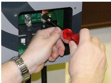
Beispielbild oben: Kabelanschluss durch die Öffnung auf der rechten Seite. Bei der Befestigung bei den Edelstahl M8 Schrauben ein Drehmoment von 9 bis 10 Nm anwenden. Die Sicherungen befinden sich hinter der linken Abdeckung.
