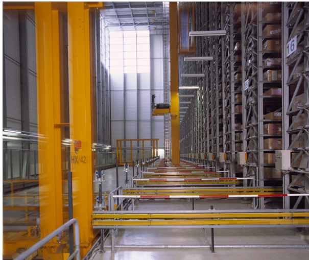
BU: Schleifleitung Programm 0831 im Hochregallager
