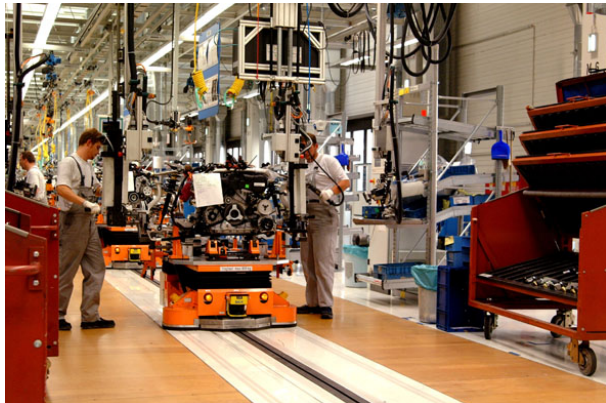
BU: IPT®-Anlage in der Motorenmontage
