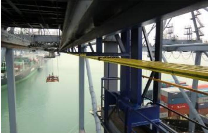
*BU: ProfiDAT® Datenübertragung von Conductix-Wampfler wird als Profil parallel zu den bestehenden Schleifleitungen an STS-Containerkränen ergänzt, oder auch als integrierte Lösung mit dem PE installiert. Die ProfiDAT® Antenne bewegt sich innerhalb des Profils und ist über Ethernet-Schnittstelle im Kontakt mit dem Transceiver.*
